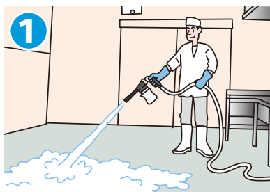
1 ハイドロフォーマーにシュアフォームプロテクト2を入れ、水道と直結し対象面に吹き付ける。
